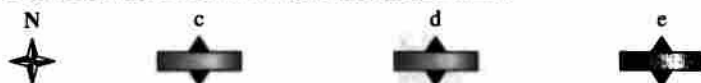
OBR. 4.8 Gyrokompas s osou rotace rovnoběžnou s rotační osou Země má snahu uchovat tento směr.
